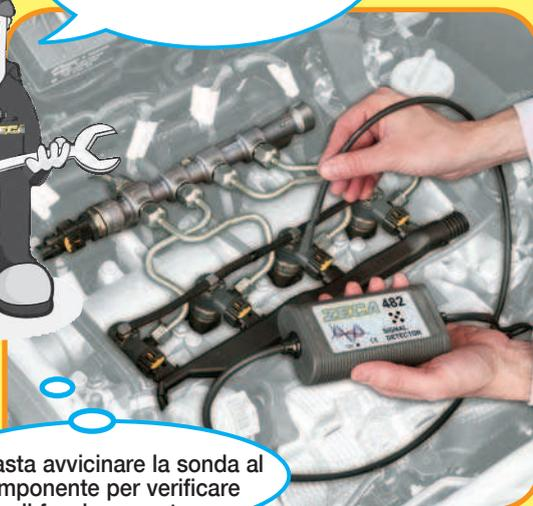
mi basta avvicinare la sonda al componente per verificare il funzionamento
